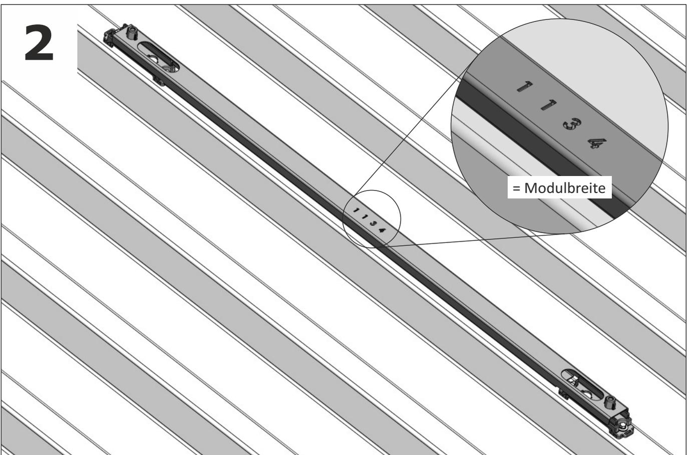
Die TrapFIX der nächsten Reihe mit einer an die Modulbreite angepassten Lehre montieren. Die lange Seite vom TrapFIX in Richtung Dachtraufe. Vorgang max. 10 Mal oder bis Feldende wiederholen. Die TrapFIX dürfen ausschliesslich mit einer Lehre montiert werden.
