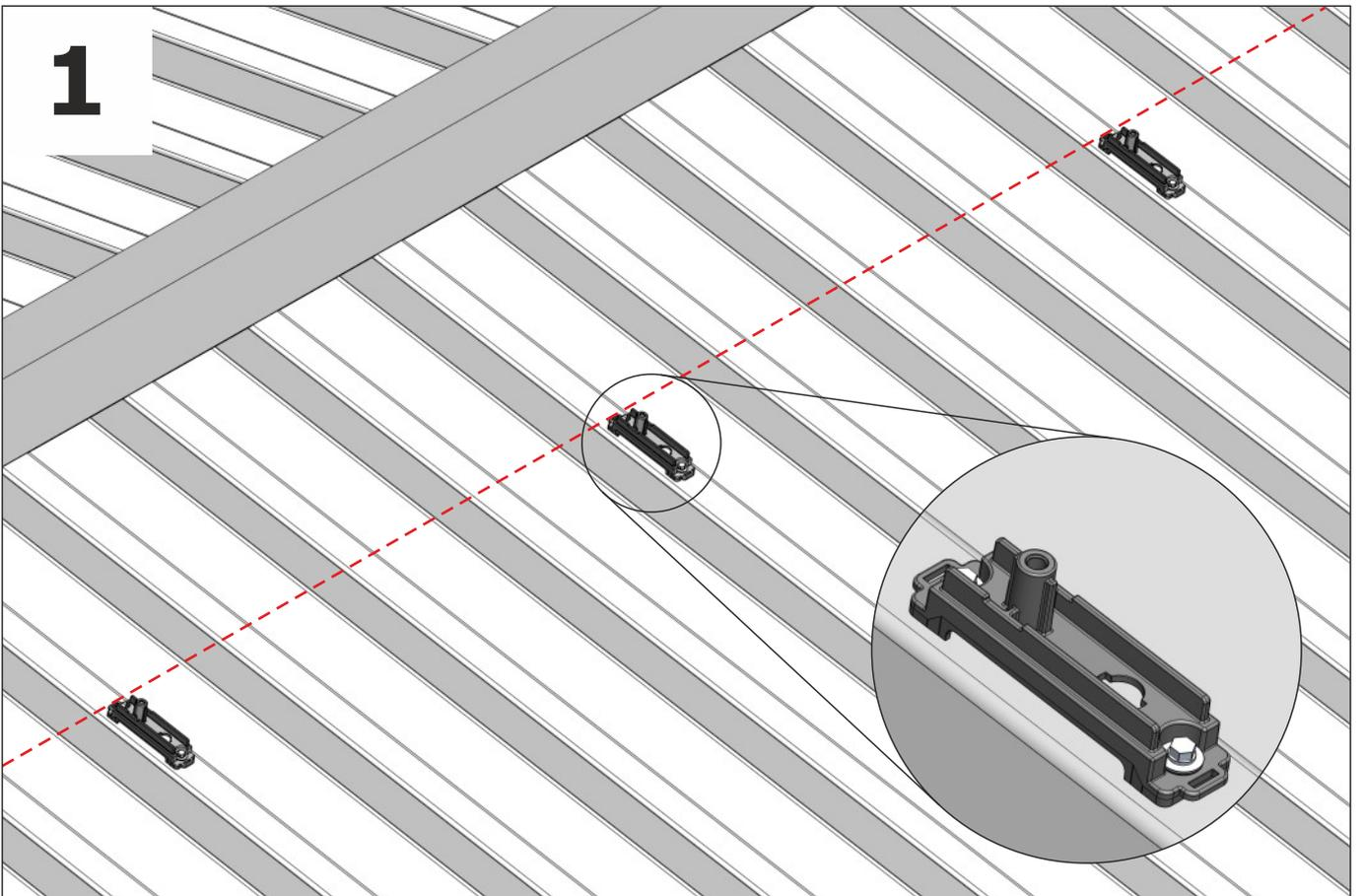
Die TrapFIX am unteren oder oberen Dachrand in einer geraden Reihe mit geeigneten Dünnschrauben ihrer Wahl montieren. Die lange Seite vom TrapFix sollte unter die Module zu liegen kommen.
