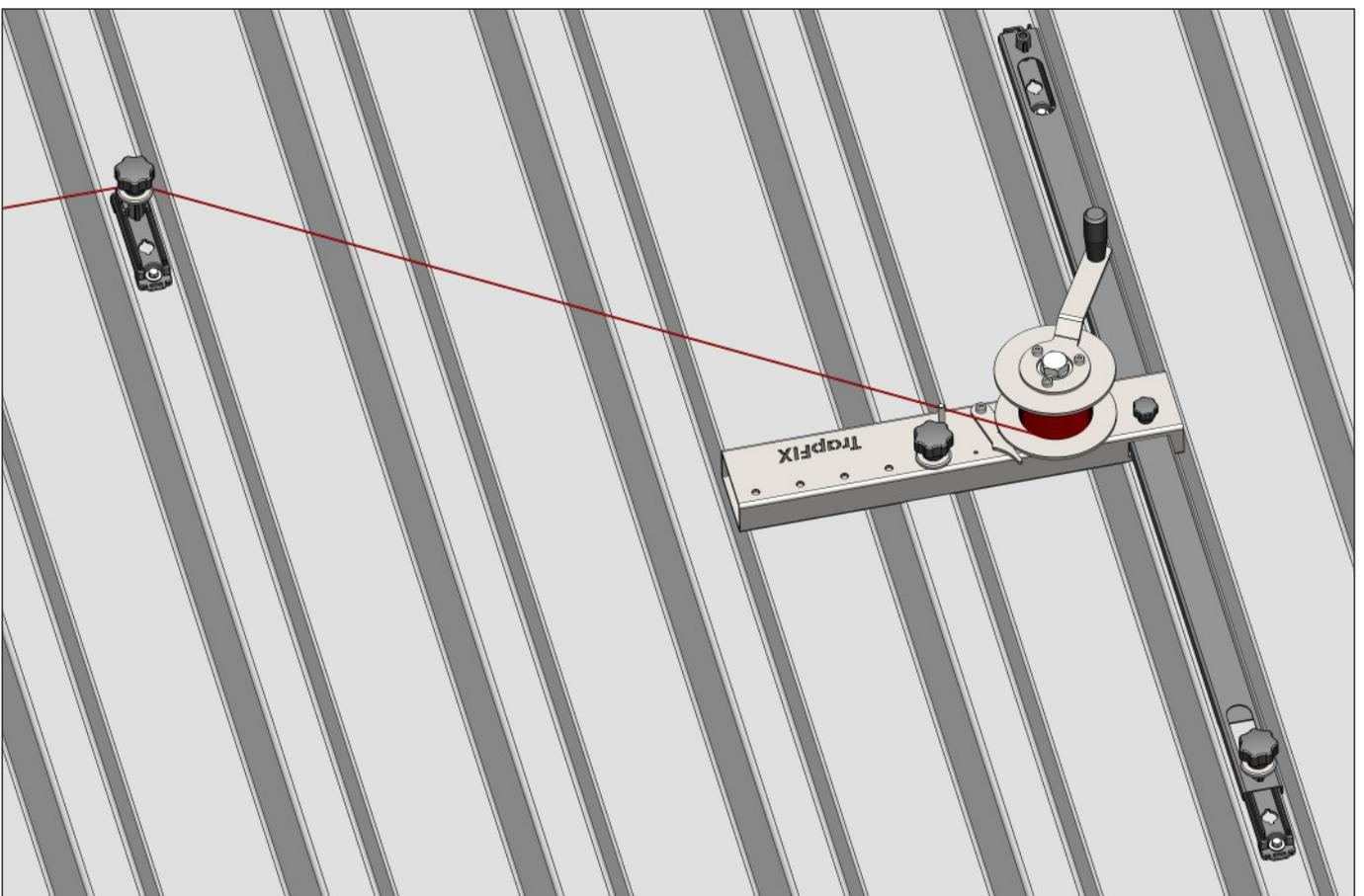
Als nächstes auf beiden Seiten das 2. TrapFIX mit dem Seil als Anschlag setzen und das Seil gemäss Bild umspannen. Anschliessend das Seil stärker spannen und als Anschlag für die oberste Reihe TrapFIX verwenden. **Achtung** Das Seil nicht beim Setzen der TrapFIX verschieben.
