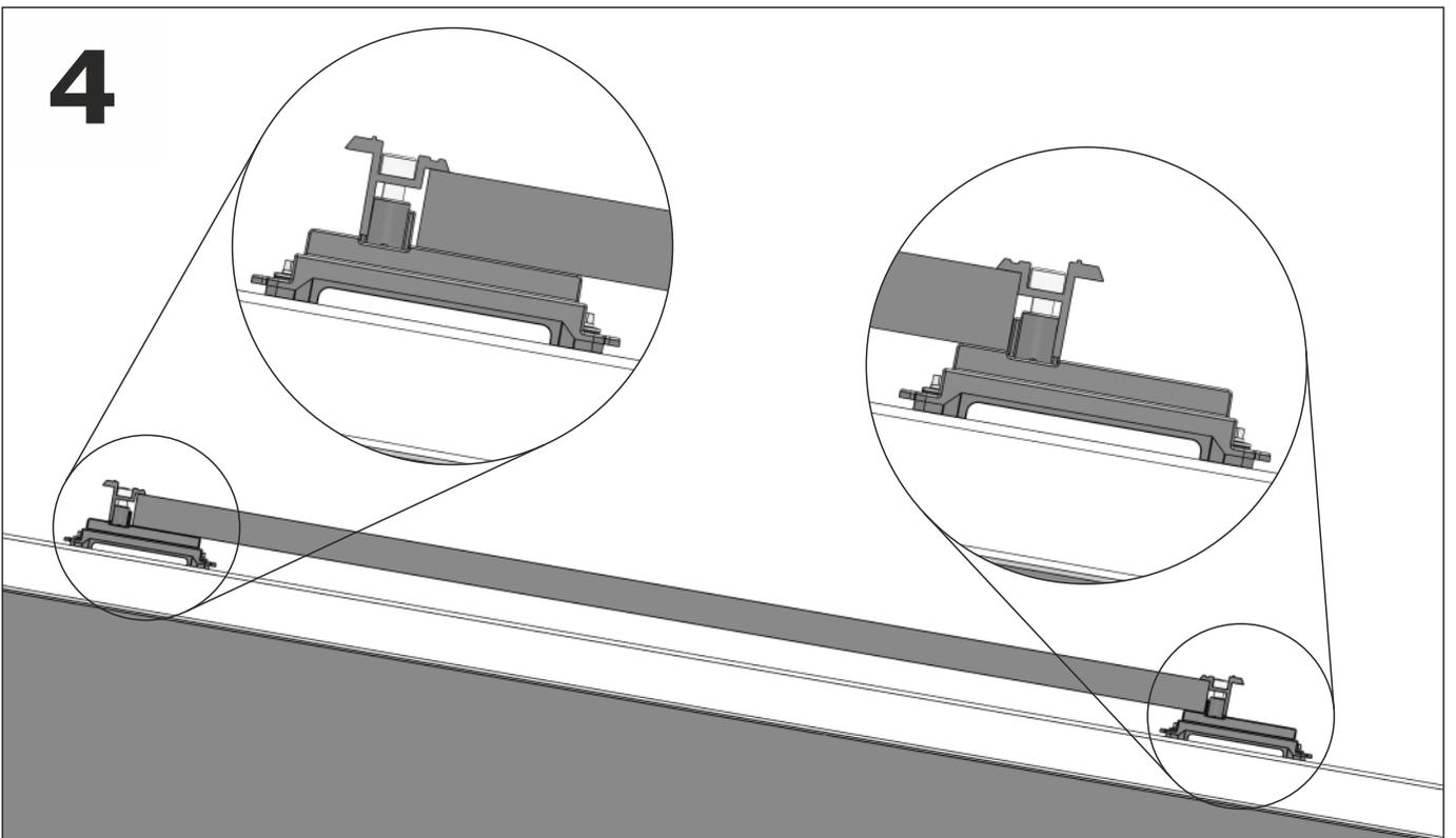
Wir empfehlen, die Module vom First in Richtung Traufe zu verlegen. Das oberste Module wird zwischen den obersten beiden TrapFIX eingelegt und an zwei Seiten geklemmt. Die Schraube soll mit 16 Nm festgezogen werden.
